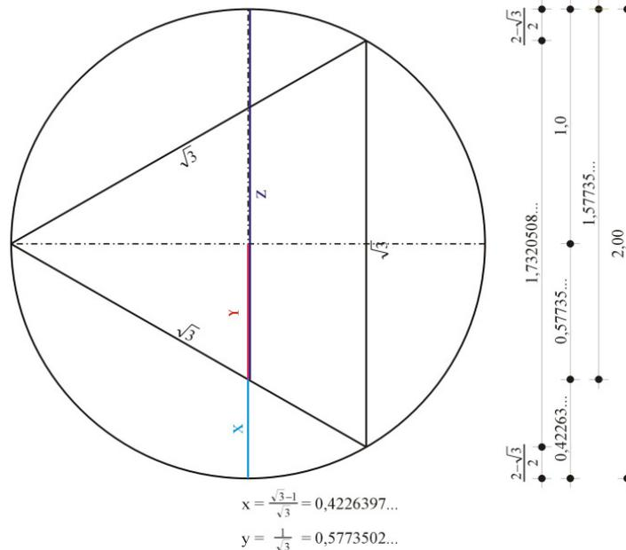
Der Wert  $y = 0,5773502\dots = \frac{1}{\sqrt{3}}$  entspricht nichts anderem als dem reziproken Wert von  $\sqrt{3}$ . Sein äußerer Ergänzungsabschnitt  $x = 0,4226397$  kann auch als  $\frac{\sqrt{3}-1}{\sqrt{3}}$  ausgedrückt werden. Die Proportion beider Werte ergibt:  $\frac{y}{x} = 1,3660254\dots = \frac{1}{\sqrt{3}-1}$ , womit erneut jener Wert auftaucht, der aus der Formel (3) abgeleitet wurde.
